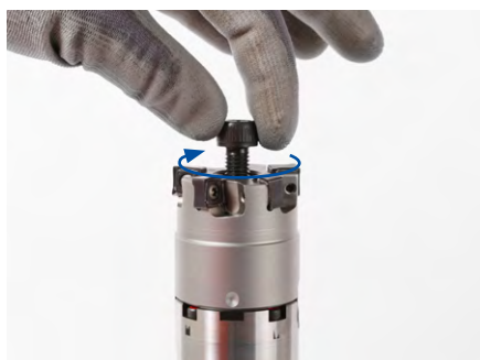
4. Ręcznie lekko wkręcić śrubę do mocowania frezu w gwintowany otwór w trzpieniu nasadowego frezu.
