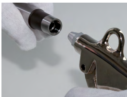
2. テーパの交換ヘッドホルダー、ネジ、接触面を圧縮空気と布で清掃します。
