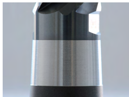
結果: 交換ミーリングヘッドの間の隙間は、フォースロックされて連結接続されています。交換ミーリングヘッドCP-Millの操作の準備が整いました。
