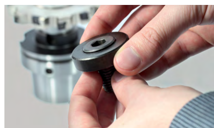
6. ねじ付きリングが1-2 mm突出するまでねじ付きボルトを回します。
