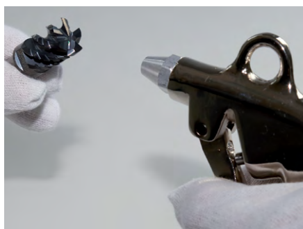
1. テーパの交換ミーリングヘッド、ネジ、接触面を圧縮空気と布で清掃します。
