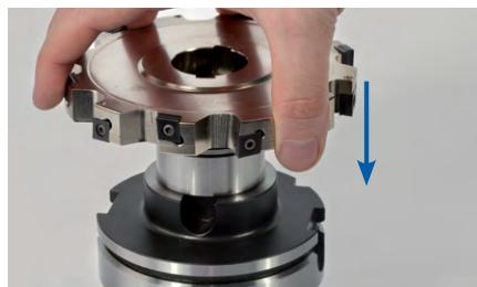
5. ミーリングカッターのアーバーにツールを平らに置きます。
