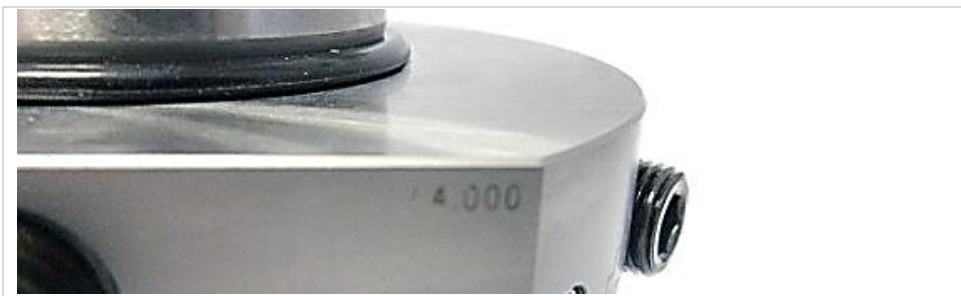
Abb. 5: Beschriftung zur Prüfung der Spannkraft
