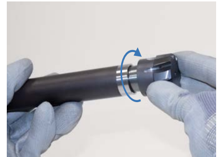
3. Den Wechselkopf im Uhrzeigersinn handfest in den Wechselkopfhalter eindrehen. Anschließend den Wechselkopfhalter samt Werkzeug in den Maschinenhalter einspannen.
