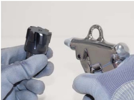
1. Den Wechselkopf an Kegel, Gewinde und Planfläche mit Druckluft und Tuch reinigen.
