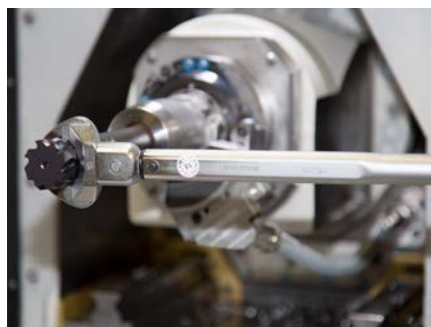
5. Den Wechselkopf mit Hilfe des Drehmomentschlüssels und dem passenden Mauleinsteckschlüssel mit angegebenem Anzugsdrehmoment festziehen (siehe Tabelle „Anzugsdrehmomente der Wechselköpfe“).
