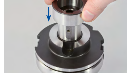
3. Placer la première bague d'écartement sur l'arbre porte-fraise.
