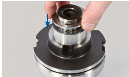
4. Placer la deuxième bague d'écartement sur la première et sur l'arbre porte-fraise.
