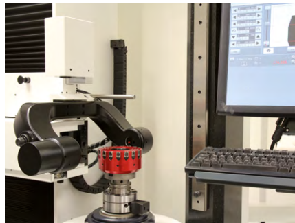
5. Mit dem Einstellgerät optisch einen Fräseinsatz -0,01\text{ mm} vor Einstellmaß (EM) einstellen. Hierzu mit der optischen Messeinrichtung die Schneidkante erfassen und die Gewindespindel mit einem Innensechskantschlüssel im Uhrzeigersinn drehen bis \text{EM} = -0,01\text{ mm} erreicht ist. Für eine rein optische Einstellung dieses Vorgehen für die restlichen Fräseinsätze wiederholen (anschließend weiter mit Schritt 7).
