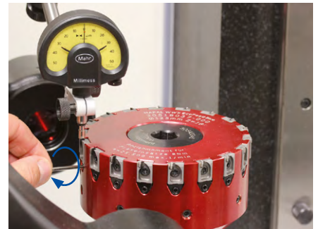
6. Die Messuhr auf dem eingestellten Fräseinsatz positionieren und auf Null setzen. Die Fräseinsätze per Messuhr 0,01\text{ mm} vor EM einstellen: Hierzu Gewindespindel mit Innensechskantschlüssel im Uhrzeigersinn drehen bis Nullmaß erreicht ist.
