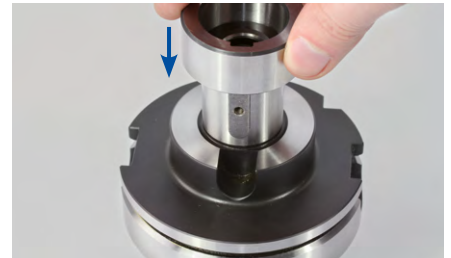
3. Den ersten Distanzring auf den Aufsteckfräserdorn aufsetzen.
