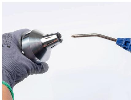
2. Den Wechselkopfhalter an Kegel und Anlagefläche mit Druckluft und Tuch reinigen.
