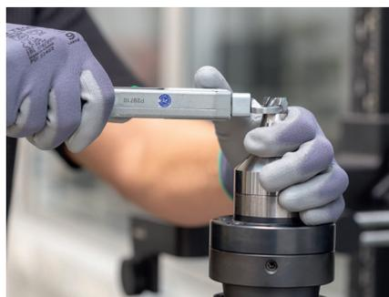
5. Den Wechselfräskopf mit Hilfe des Drehmomentschlüssels, dem passenden Mauleinsteckschlüssel und dem angegebenen Anzugsdrehmoment anziehen (siehe Tabelle „Anzugsdrehmomente der Wechselfräsköpfe“).
