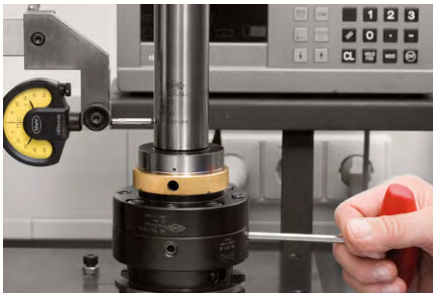
4. Messuhr an der Rundlaufkontrollstelle in Position bringen. Bei MAPAL Werkzeugen kann auch am HSK-Bund ausgerichtet werden. Tiefsten Messpunkt aufnehmen und Messuhr auf „null“ bringen. Radialausrichtung vornehmen.
