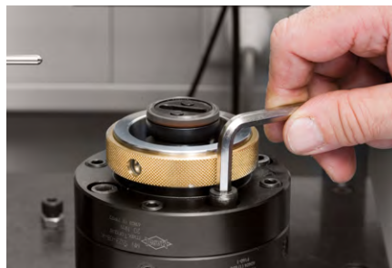
2. Vorsatzflansch einfügen. Befestigungsschrauben anlegen.
