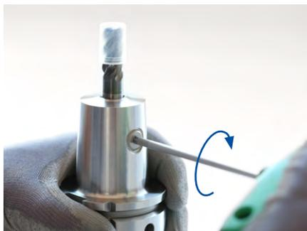
5. 将扭矩扳手设置到所指定的拧紧扭矩（参见“夹紧螺钉的拧紧扭矩”表格）。
