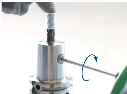
3. 将刀具从上方压紧。同时，将夹紧螺钉以顺时针方向直到止挡位置旋转。
