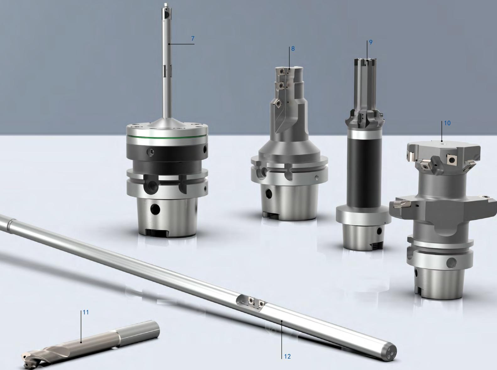
7 带有 MQL 的精镗刀具，设计有刀片和 PCD 导条，用于阀门孔的  $\mu\text{m}$  级精度加工。
