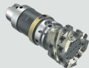
切削負荷を抑えた異なる穴径の前加工が可能 PCD スローアウェイインサートを搭載 ISO ヘリックスフライスカッター、HSK-A63
