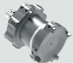
ステータ穴の仕上げ加工用 付加製造法による製造、 Ø 220 / 225 mm、HSK-A63 - max. 8.5 kg
