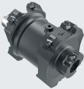
TEC インサート + EAシステム搭載ファインボーリングツール 外径 70 / 185 mm、HSK-A63 - max. 11.5 kg
