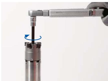
5. トルクレンチをミーリングカッターメーカーが推奨する締め付けトルクに設定します。
