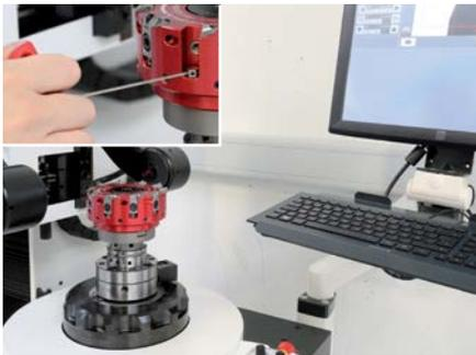
**7. セッティングフィクスチャー(光学式)による調整**
