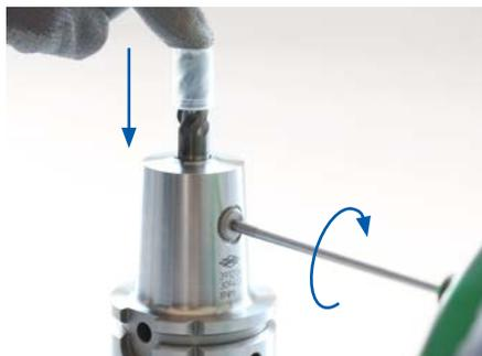
3. ツールを上から押しながらクランプネジを時計回りに回し、シャンクの凹部に入りますようにします。
