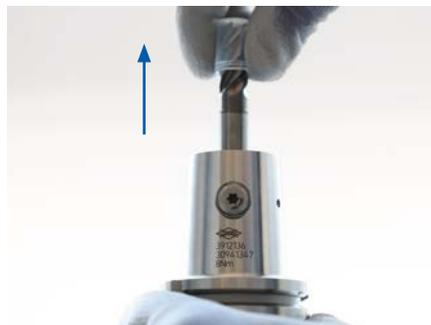
2. ミルチャックの挿入穴からツールを取り外せます。
