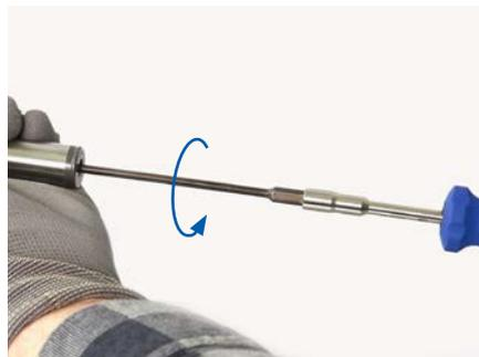
6. 専用クランピングネジを締め付けトルクで取り付けること
