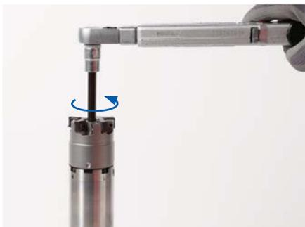
1. レンチを使用して、ミーリングカッターの締め付けねじを緩めます。
