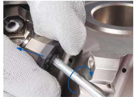
4. インサートを45°の角度で外側に引き、同時にTORX PLUS®ねじがかちっとはまるまでねじ込みます。
