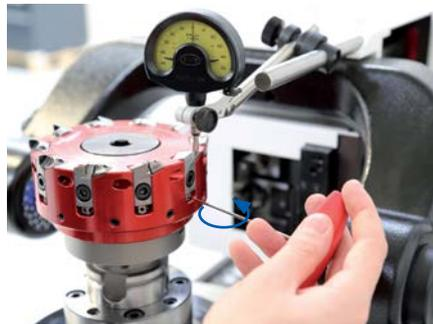
**8. ダイヤルゲージ(測定プレート)による調整**
