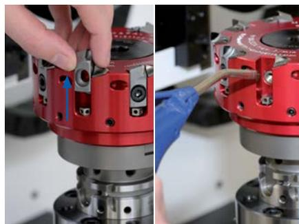
2. ミーリングカートリッジをミーリングカートリッジのシートから上方に取り出します。次にミーリングカートリッジのシートを圧縮空気で完全に清掃します。
