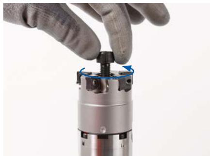
2. ミーリングカッターの締め付けねじをネジ穴から外して取り出します。
