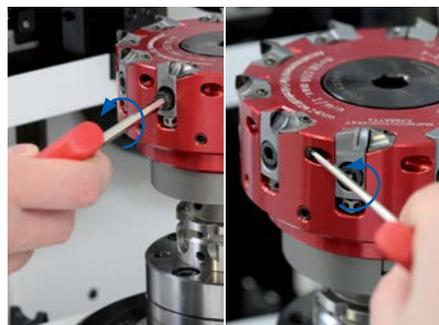
1. ミーリングカートリッジ用のクランプネジを緩めて取り外します。
