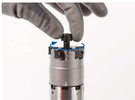
4. ミーリングカッターの締め付けねじを手でフライスアーバーのネジ穴に軽くねじ込みます。
