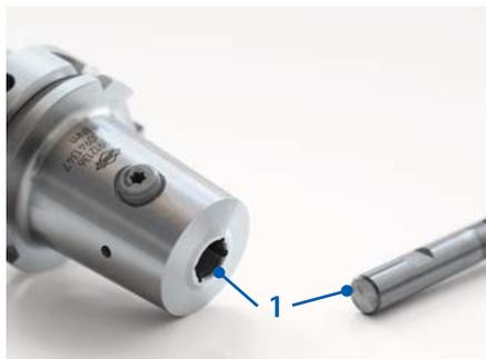
1. 挿入穴とツールシャンクを清掃します(図示 1)。
