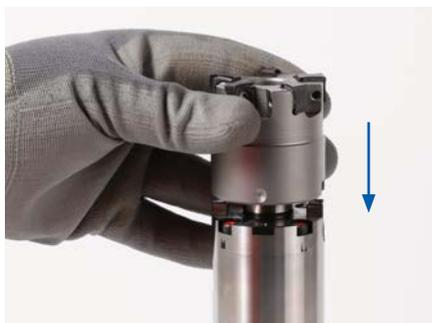
2. ミーリングアーバーを刃具交換台に固定します。
