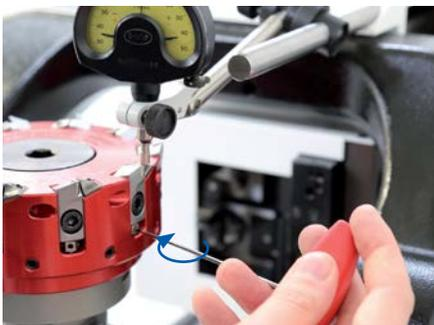
**10. 視覚的あるいは触覚的に最も突き出している刃先があるミーリングカートリッジを確定し、ダイヤルゲージをゼロに設定します。ダイヤルゲージですべてのミーリングカートリッジを最高部にある刃先に合わせて調整**
