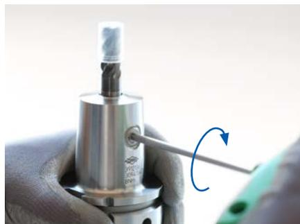
5. トルクレンチを指定の締め付けトルク(263ページの「クランプネジの締め付けトルク」表参照、またはミルチャック本体のマーキングで確認)に設定します。
