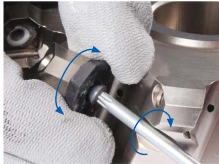
3. TORX PLUS®レンチを使用してTORX PLUS®ねじを時計回りに回し、同時にインサートを繰り返し軽く揺り動かしながらインサートシートに挿入します。
