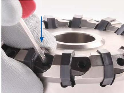
3. インサートを押し下げ、インサートが周縁部の両方の接触面に密着していることを確認してください。
