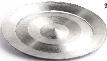
貫通穴の場合、ドリルが出るときに鋭いエッジの穴カバーもしくはディスクが落下します。これらが飛ばされて、損傷や怪我をする危険があります。これを回避するために、適切な保護対策を講じる必要があります。
