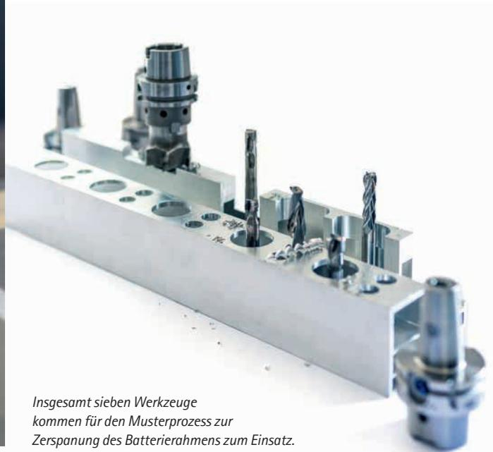
Insgesamt sieben Werkzeuge kommen für den Musterprozess zur Zerspänung des Batterierahmens zum Einsatz.
