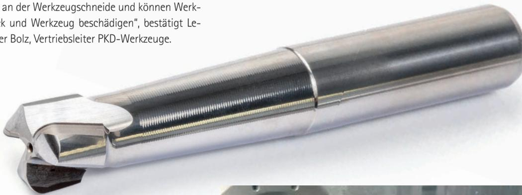
PKD-bestückte Hochvolumenfräser des SPM-Programms.
