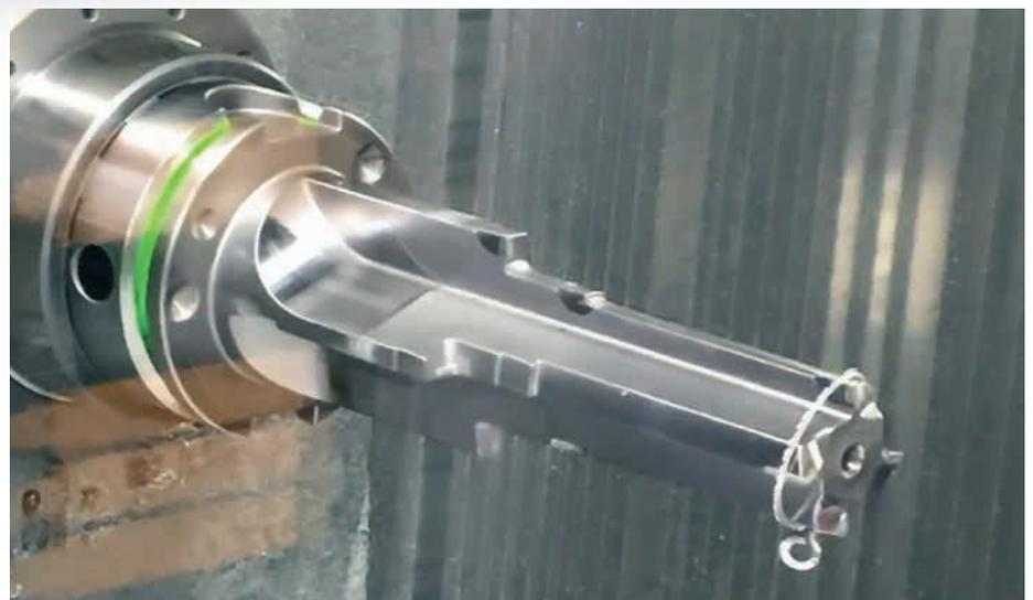
Späneknäuel können sich bei langspanenden Aluminiumwerkstoffen in der Maschine oder am Werkzeug festsetzen und Störungen verursachen.
