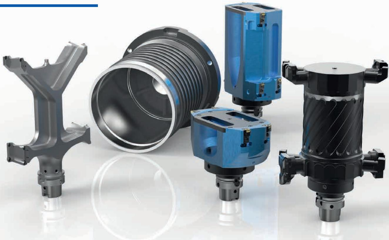
Das „Performance“ Werkzeugpaket ist auf mittlere Fertigungsstückzahlen hin optimiert. Das Bild zeigt die Bearbeitungslösung mit HSK-63 für Statorgehäuse
