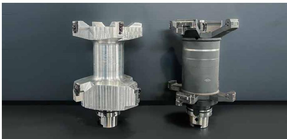
*Unter den 40 verschiedenen Werkzeugen, die zur Produktion eines Statorgehäuses erforderlich sind, spielen zwei Sonderwerkzeuge von MAPAL eine entscheidende Rolle: Das Werkzeug mit Wendeschneidplatten für die Semi-Finish-Bearbeitung (links) und ein Feinbohrwerkzeug für die Finish-Bearbeitung.*
