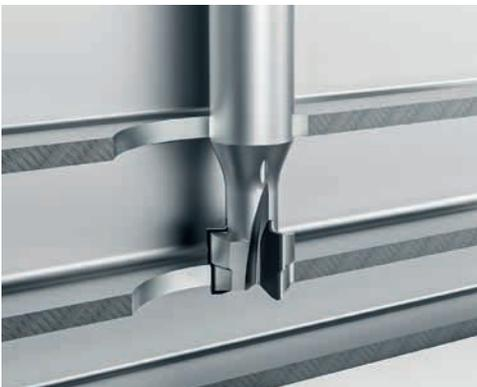
Der speziell ausgelegte PKD-Fräser bearbeitet die beiden Bohrungen mit unterschiedlichen Durchmessern
