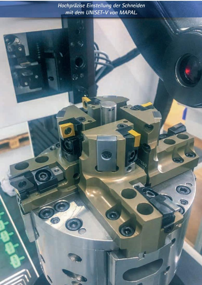
*Das vierschneidige Aussteuerwerkzeug steht für hohe Prozesssicherheit und Flexibilität bei der Bearbeitung von Statorbohrungen.*
