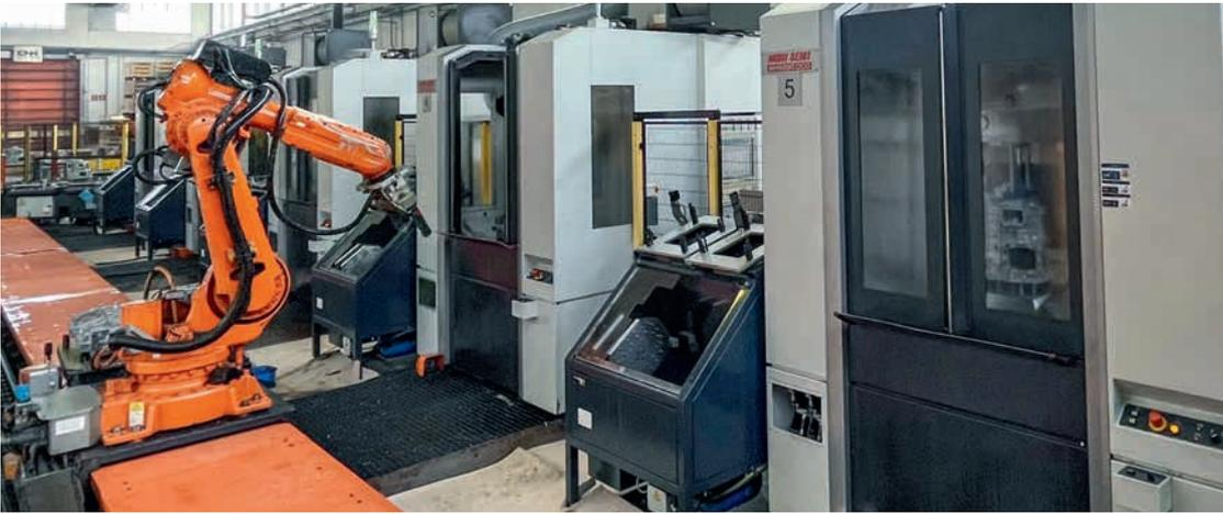
*Auf elf Bearbeitungszentren fertigt 2A in Turin hochpräzise Statorgehäuse für Elektromotoren. Eine besondere Herausforderung war dabei die erforderliche Wiederholgenauigkeit bei der Zerspanung dieser dünnwandigen Bauteile.*
