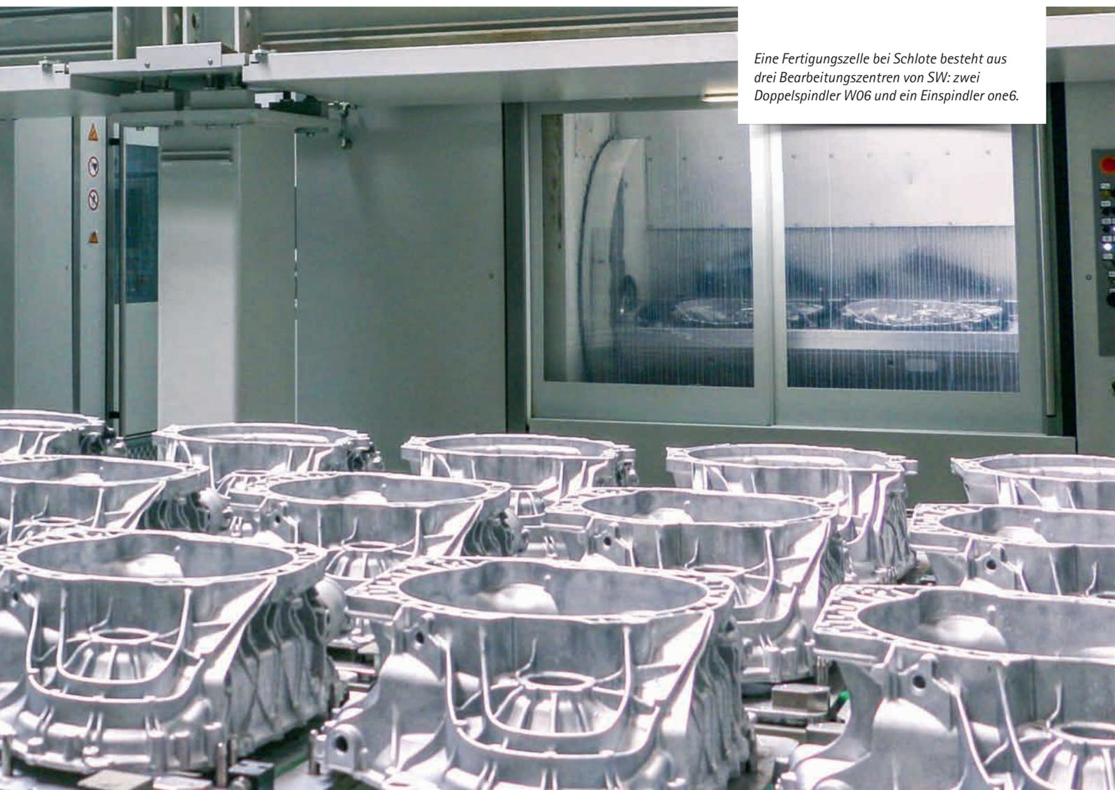
*Eine Fertigungszelle bei Schlote besteht aus drei Bearbeitungszentren von SW: zwei Doppelspindler W06 und ein Einspindler one6.*
