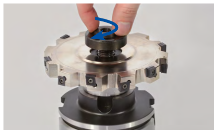
7. Avvitare leggermente la vite di serraggio corpo fresa in senso orario sul mandrino per fresa a manicotto.
