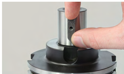
2. Inserire la linguetta di aggiustamento sul mandrino per fresa a manicotto.
