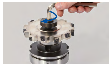
8. Tramite una chiave a brugola ruotare ancora la vite di serraggio corpo fresa in senso orario e quindi stringerla con una chiave dinamometrica (per la coppia di serraggio vedere la tabella "Coppia di serraggio per vite di serraggio corpo fresa").
