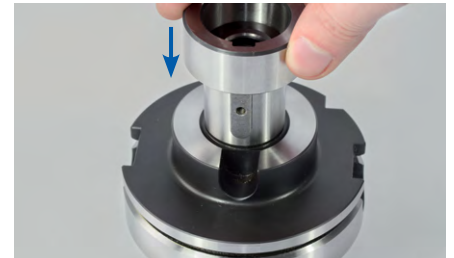
3. 1番目のスペーサーリングをミーリングカッターのアーバーに載せます。
