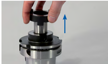
1. ミーリングカッターのアーバーからフランジ付スリーブを取り外します。
