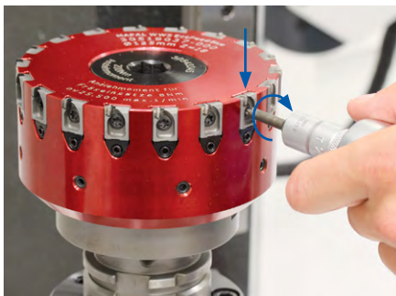
4. 締め付けながらミーリングカートリッジを軽く押すと、調整ウェッジが密接します。 ミーリングカートリッジのクランプネジ**を挿入し、時計回りに1-2 Nmで締め付けます。
