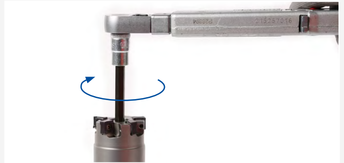
5. トルクレンチをミーリングカッターメーカーが要求する締め付けトルクに設定します。
