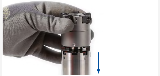
2. フライスアーバを交換装置に固定します。
