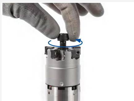
2. ミーリングカッターの取付けボルトをネジ穴から外して取り出します。
