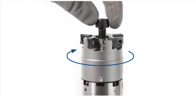
4. ミーリングカッターの取付けボルトを手でフライスアーバのネジ穴に軽くねじ込みます。
