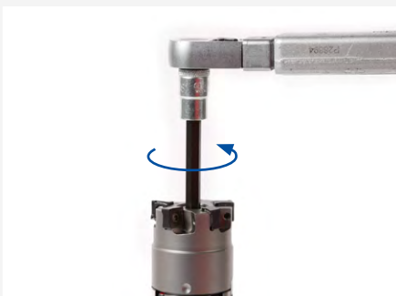
1. 例えばトルクレンチを使用して、ミーリングカッターの取付けボルトを緩めます。
