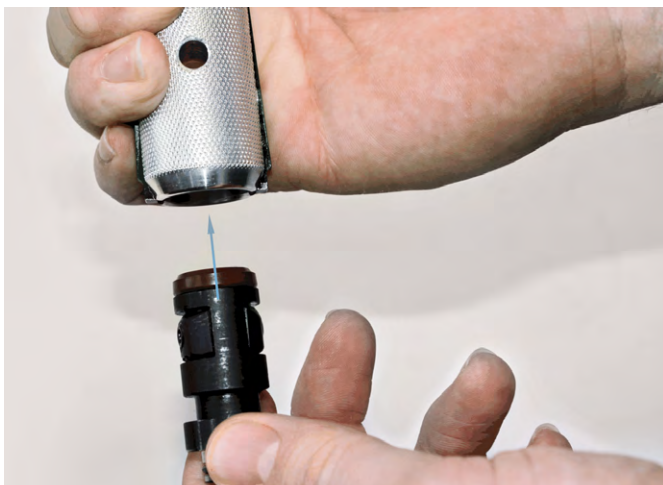
KSクランピングカートリッジをKSアセンブリプライヤーに挿入する
