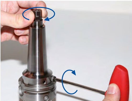
図1: クランピングスクリューとテストバーを回す
