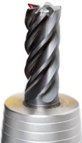
Detailansicht eines Vollhartmetall-Schaftfräasers mit projiziertem Laserpunkt zum groben Anvisieren der Messposition.
