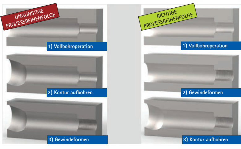
Bild 9: Optimierung der Bearbeitungsreihenfolge hinsichtlich liegendebliebener Späne
