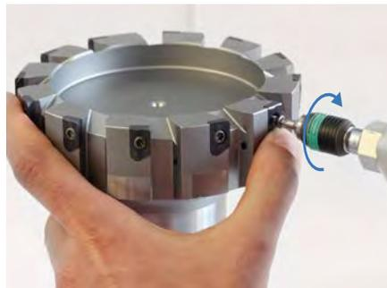
5. **Hinweis:** Die TORX®-Schrauben nur mit einem passenden Drehmomentschlüssel anziehen.
