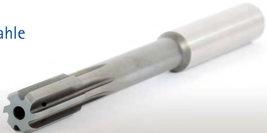
Die bewährten FixReam Hochleistungsreibahlen bietet MAPAL nun als Variante aus beschichtetem Schnellarbeitsstahl (HSS) mit Innenkühlung an. Bohrungsqualitäten im Bereich von IT7 werden mit dem gerade genuteten Werkzeug prozesssicher erreicht. Das Programm beinhaltet Hochleistungsreibahlen im Durchmesserbereich von 3 bis 40 mm für die Bearbeitung von Stahl, Guss, Aluminium sowie CFK und GFK. Im Vergleich zu Standard HSS-Reibahlen erzielt die FixReam Hochleis-
