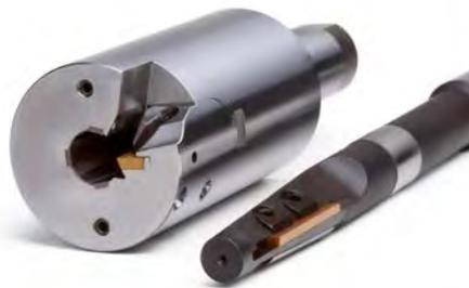
Mit Außenreibwerkzeugen können Außendurchmesser und Wellen  $\mu\text{m}$ -genau und rationell bearbeitet werden. Das Prinzip des MAPAL Außenreibens besteht darin, die Schnittkräfte durch Führungsleisten optimal aufzunehmen und abzustützen, so dass auf das Werkstück keine Abdrängungskräfte und Biegemomente einwirken.
