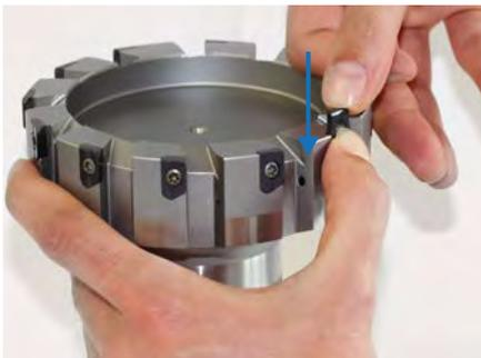
4. Die neue Schneidplatte bis zur Hälfte in den Schneidplattensitz legen. Anschließend die Schneidplatte mit dem Daumen leicht in den Schneidplattensitz drücken und gleichzeitig die Schneidplatte axial nach unten in die Endposition schieben.
