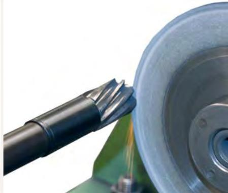
Um das volle Potenzial der festen mehrschneidigen Reibahlen ausschöpfen zu können, bietet MAPAL einen Nachschleif- und Reparaturservice für gebrauchte Werkzeuge an. Die Reibahlen können in der Regel nach Erreichen des Standzeitendes mehrfach nachgeschliffen werden. Vor allem bei den Hochleistungs-Reibahlen, wird durch das Nachschleifen beziehungsweise durch eine Neubestückung der Nutzungsgrad jedes Werkzeuges erheblich verbessert.
