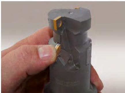
5. Die Wendeplatte austauschen oder drehen. Anschließend die Wendeplatte in die Kassette einsetzen.
