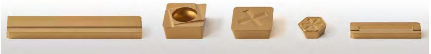
Die Schneidstoffsorten wurden speziell für das Reiben entwickelt. Die bisher bekannten CVD-Beschichtungen sind zwar durch extrem harte Beschichtungsanteile verschleißfest, jedoch gleichzeitig sehr spröde und bruchempfindlich. Durch die spezielle Prozessführung bei der Herstellung der neuen CVD-Beschichtung ist diese deutlich zäher als bisher bei gleichzeitig guter Verschleißfestigkeit. Die
