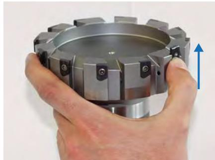
2. Die Schneidplatte vorsichtig in axialer Richtung aus dem Schneidplattensitz schieben und entnehmen. Die übrigen Schneidplatten entnehmen, hierfür die Handlungsschritte 1 und 2 wiederholen.
