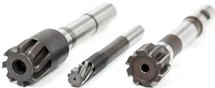
Hochleistungs-Reibahlen für die Stahl- und Gussbearbeitung mit optimierter Kühlmittelführung in fester und dehnbarer Ausführung in Vollcermet oder mit Cermetschneiden bestückt.
