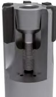
Die MonoReam Reibahlen der Baureihe 700 werden als festes Werkzeug eingesetzt, jedoch ist diese Baureihe für das Nachschleifen optimiert. Durch eine einteilige Dehnschraube wird die Reibahle im Durchmesser aufgeweitet. Das Dehnsystem eignet sich lediglich zur Kompensation vor dem Nachschleifen und nicht zum Ein- oder Nachstellen des Durchmessers. Durch das Aufweiten des Durchmessers ist es möglich, alle Funktionsflächen nachzuschleifen, sowohl im Anschnitt, als auch im Werkzeugdurchmesser.
