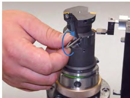
9. Das Überstands- oder Absolutmaß der Wendeplatte einstellen, hierzu mit einem Innensechskantschlüssel den Gewindestift im Uhrzeigersinn drehen.
