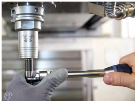
5. Hinweis: Die freie Hand an den Wechselfräskopf legen, um eine feinfühligte Abstimmung durchführen zu können. Dadurch kann das Anzugsdrehmoment genauer eingestellt werden.
