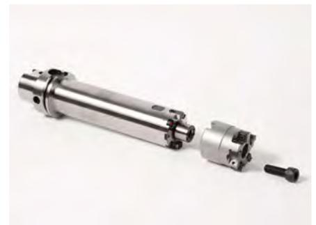
3. Das Werkzeug vom Fräseraufsteckdorn entnehmen.
