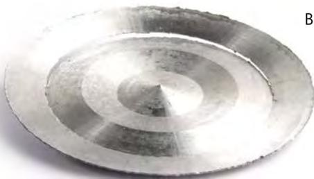
Bei Durchgangsbohrungen fällt beim Austritt des Bohrers ein scharfkantiger Bohrungsdeckel bzw. eine Scheibe ab. Es besteht die Gefahr, dass diese weggeschleudert wird und es dadurch zu Schäden und Verletzungen kommt. Um dies zu vermeiden, sind dementsprechende Schutzvorkehrungen zu treffen.
