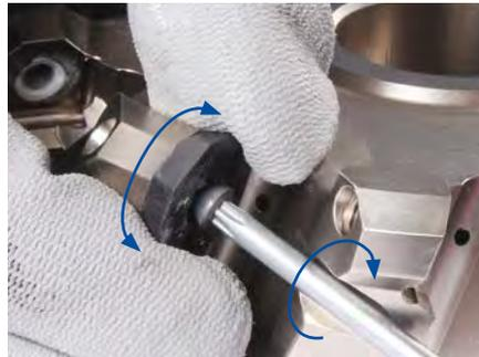
3. Mit einem TORX PLUS®-Schlüssel die TORX PLUS®-Schraube im Uhrzeigersinn eindrehen, gleichzeitig die Wendeschneidplatte mit wiederholenden leichten Wippbewegungen in den Plattensitz einsetzen.
