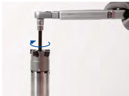
5. Einen Drehmomentschlüssel auf das vom Fräserhersteller geforderte Anzugsdrehmoment einstellen.
