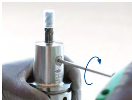
5. Einen Drehmomentschlüssel auf das angegebene Anzugsdrehmoment (siehe Tabelle "Anzugsdrehmomente der Spanschraube" auf Seite 263) einstellen.
