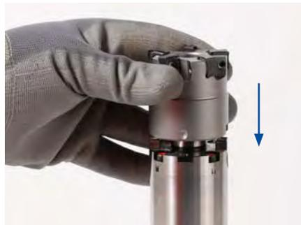
2. Den Fräseraufsteckdorn in eine Wechsellvorrichtung einspannen.
