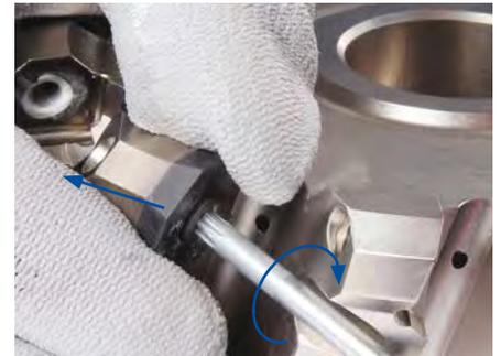
4. Die Wendeschneidplatte im 45°-Winkel nach außen ziehen und gleichzeitig die TORX PLUS®-Schraube bis zum Anschlag eindrehen.
