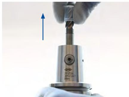
2. Das Werkzeug aus der Aufnahmebohrung des Flächen-spännfutters entnehmen.
