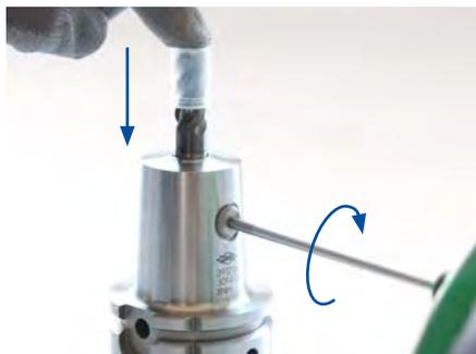
3. Das Werkzeug von oben andrücken. Gleichzeitig die Spanschraube im Uhrzeigersinn bis zum Anschlag drehen.
