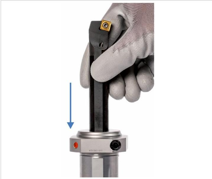
Abb. 19: Werkzeug einschieben
