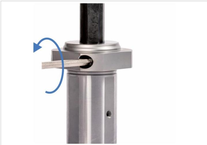
Abb. 22: Spannschraube lösen
