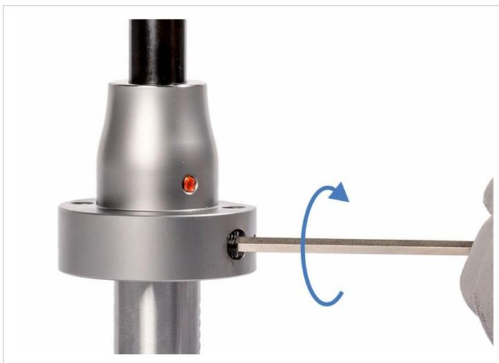
Abb. 16: Spannschraube 2 anziehen
