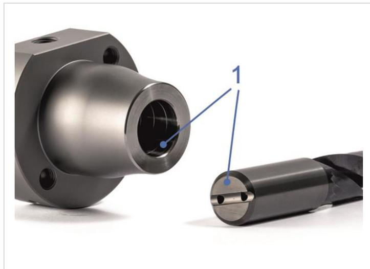
Abb. 7: Dehnspannfutter und Werkzeug reinigen
