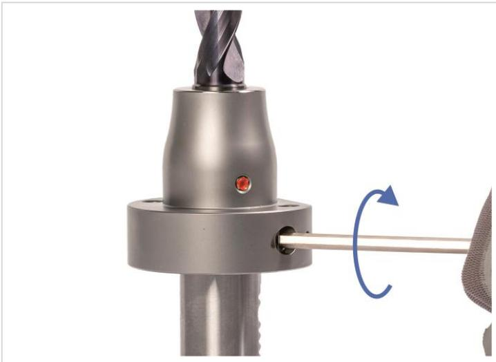
Abb. 11: Spanschraube 2 anziehen
