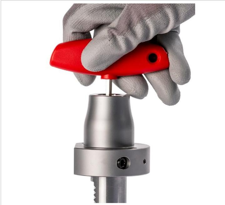
Abb. 8: Werkzeuglänge einstellen (axial)
