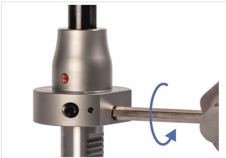
2. Lösen Sie die Klemmschraube mit Hilfe des passenden Innensechskant-schlüssels mit Quergriff.
