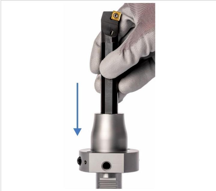
Abb. 14: Werkzeug einschieben
