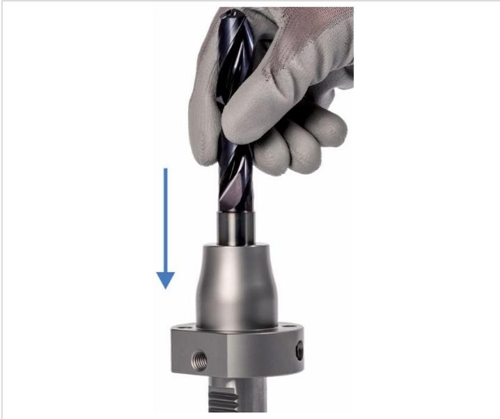
Abb. 10: Werkzeug einschieben
