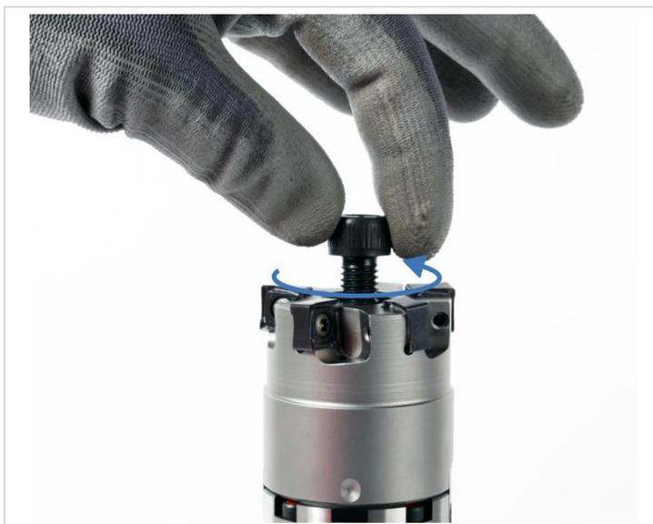
Abb. 7: Fräseranzugsschraube entnehmen
