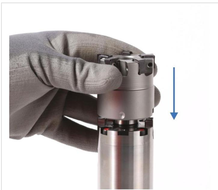
Abb. 3: Werkzeug aufsetzen
