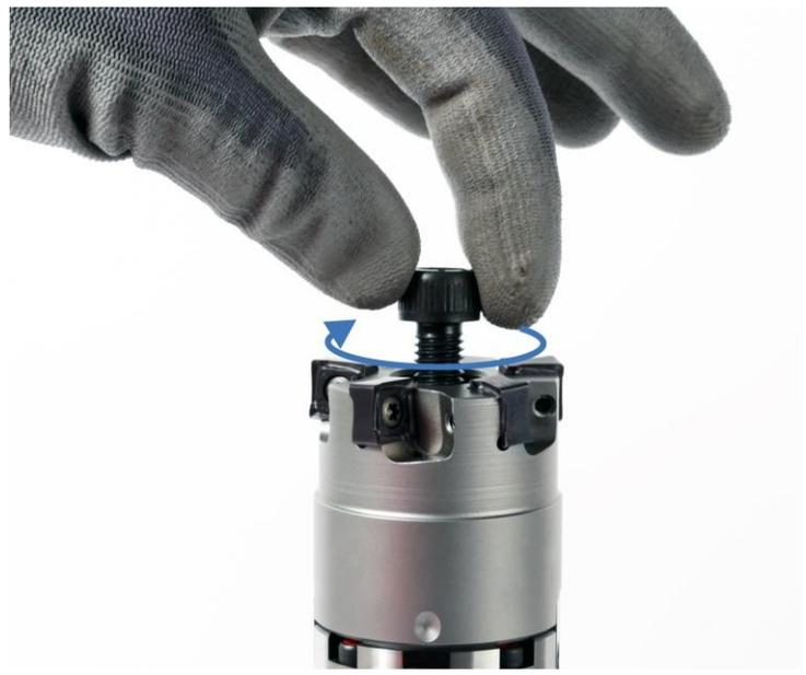
Abb. 4: Fräseranzugsschraube eindrehen
