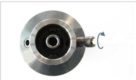
Abbildung 10: Einschrauben der Spanschraube in Anschlusskontur der Maschinenspindel
