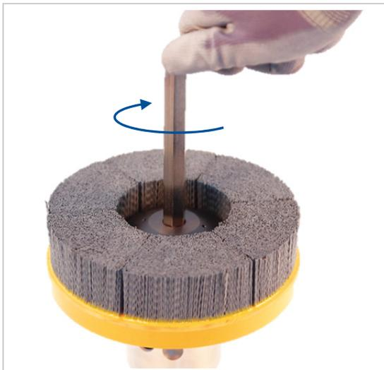
Abbildung 4: Anzugsschraube bis Anschlag handfest anziehen
