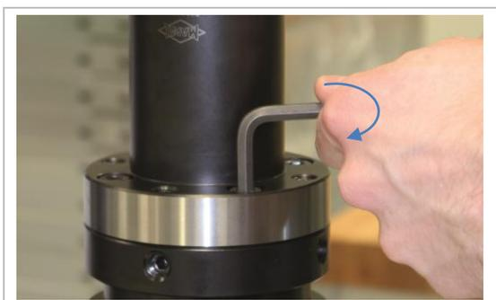
Abbildung 11: Axiale Befestigungsschrauben zu 50% anziehen
