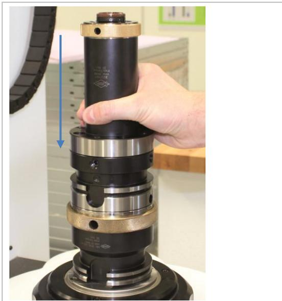
Abbildung 4: KS-Vorsatzflansch einsetzen
