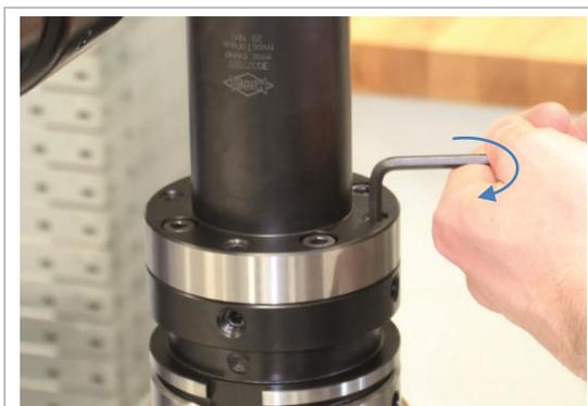
Abbildung 16: Axiale Winkelausrichtschrauben exakt anziehen
