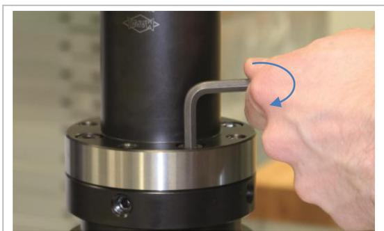
Abbildung 5: Axiale Befestigungsschrauben mit ca. 2 Nm festziehen
