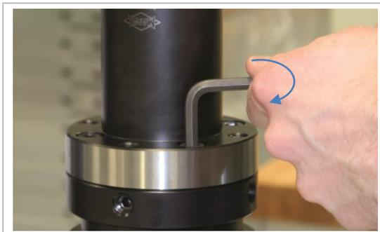
Abbildung 15: Axiale Befestigungsschrauben exakt anziehen
