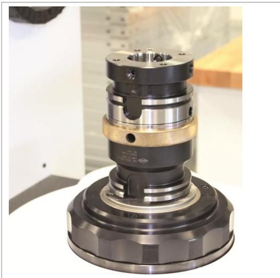
Abbildung 3: HSK-Adapter in Schnittstelle des Einstellgerätes
