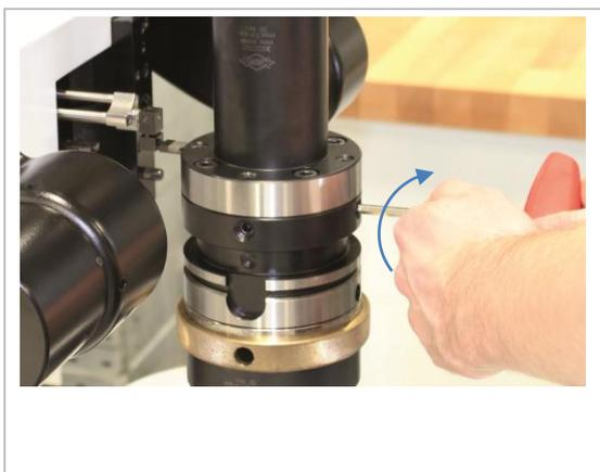
Abbildung 10: Radiale Justierschrauben drehen
