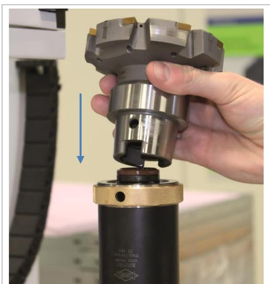
Abbildung 6: TFB-Feinbohrkopf einfügen
