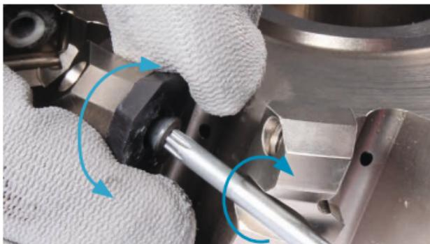
3. Mit einem TORX PLUS®-Schlüssel die TORX PLUS®-Schraube im Uhrzeigersinn eindrehen, gleichzeitig die Wendeschneidplatte mit wiederholenden leichten Wippbewegungen in den Plattensitz einsetzen.
