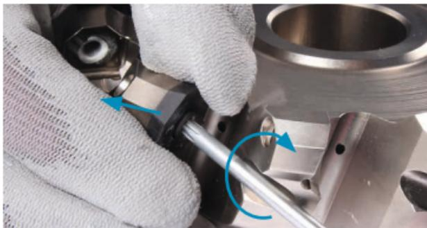
4. Die Wendeschneidplatte im 45°-Winkel nach außen ziehen und gleichzeitig die TORX PLUS®-Schraube bis zum Anschlag eindrehen.
