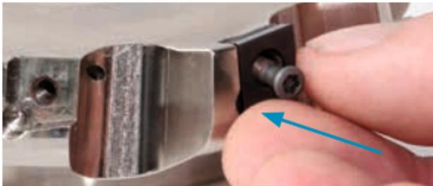
4. Die Spannschraube in das Schraubenloch der Wendeschneidplatte drehen.
